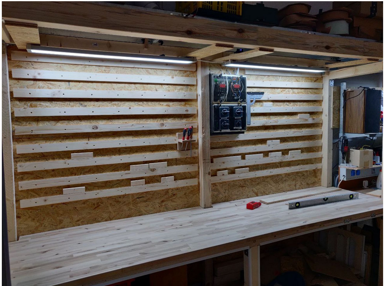
Abbildung 7: Einige Wochen nach dem Regalbau wurde die Wand mit Keilleisten (French Cleat System) ausgestattet
