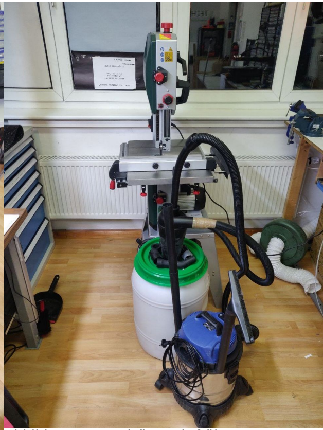
Abbildung 9: Bandsäge mit früherer Staubabsaugung
