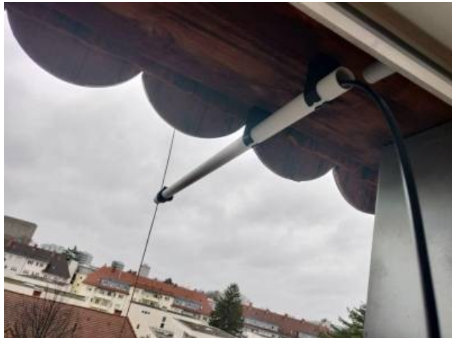
Figure 2: Meine Eigenbau Antenne MX-1 fuer das 2m und 70cm Band vom Nov 2021. Dokumentation ist im Wiki.
